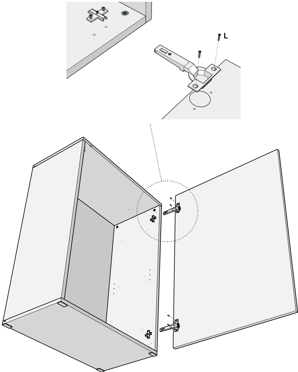
POSSIBILE MONTAGGIO IN ENTRAMBI I LATI DEL MOBILE
